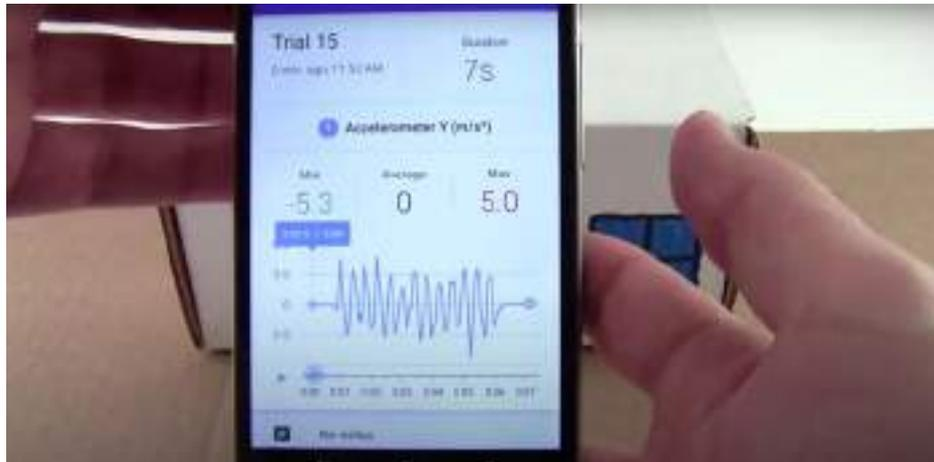
Pegaremos con un poco de celo o cinta de doble cara el móvil a la caja para que recoja la oscilación de esta y no la suya propia, colocaremos la caja encima de la base y moveremos desde un lateral hacia delante y detrás repetidamente para simular el terremoto.
